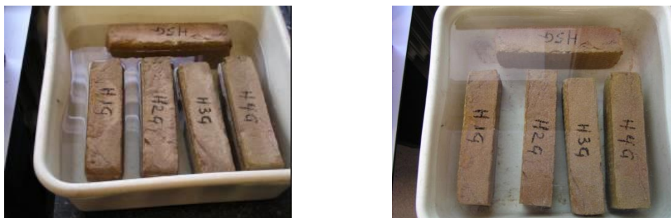
Figuur 5. Onderdompeling in twee fasen: eerst gedeeltelijk (links) zodat lucht uit het monster kan ontsnappen, vervolgens geheel (rechts).
